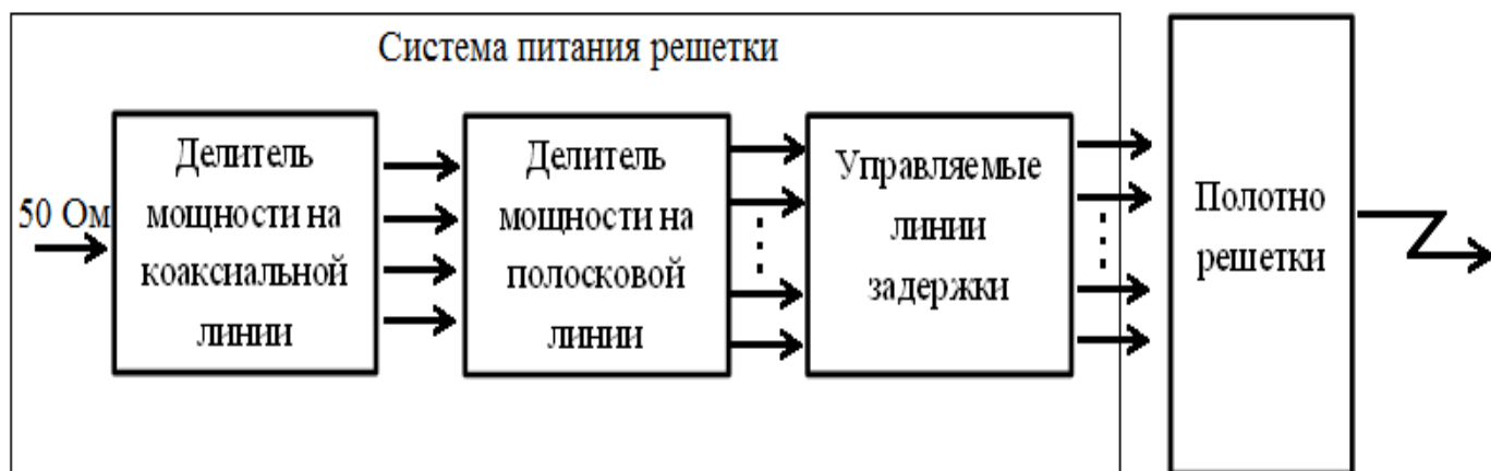
Рис. 2.1. Функциональная схема антенной решетки с системой питания
