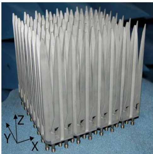
Рис. 3.1. Плоская двумерно- периодическая двух- поляризационная антенная решетка из 64 элементов (8x8) в виде неоднородной щелевой линии.
